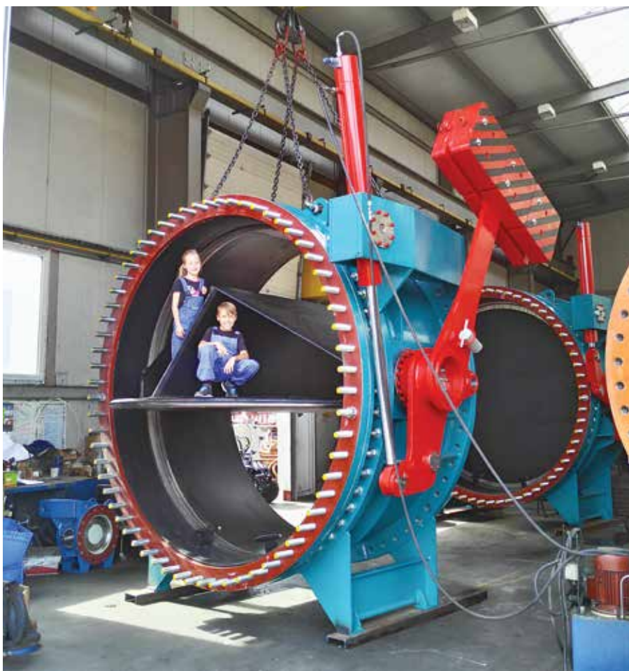
Klapkový uzávěr DN2800 PN4/6, projekt: HPP LINTAU, Indonésie, rok realizace: 2016
