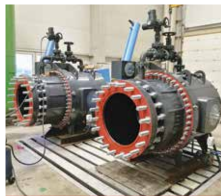
Kulový uzávěr DN800 PN40, projekt: HPP ZANA, Peru, rok realizace: 2018
